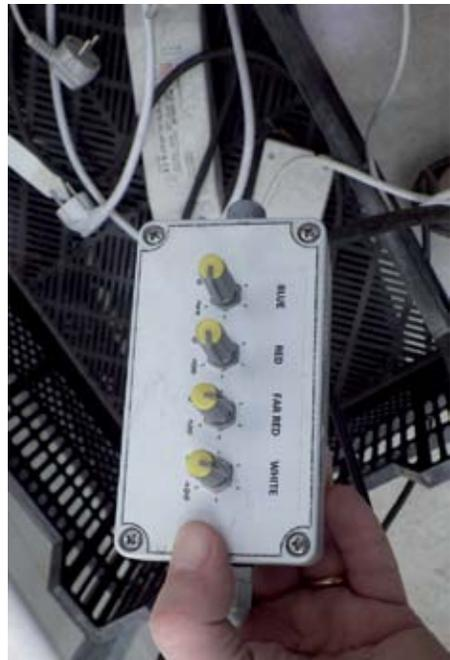
Abb. 3: vierfärbig gedimmte LEDs Abt. 13    Abb. 4: Schaltkonsole für gedimmte LEDs Abt. 13
